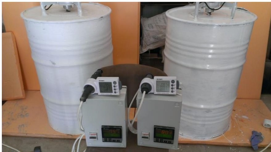
Рис. 5. Общий вид бочек, окрашенных краской на основе микросфер (слева) и обыкновенной краской (справа)
