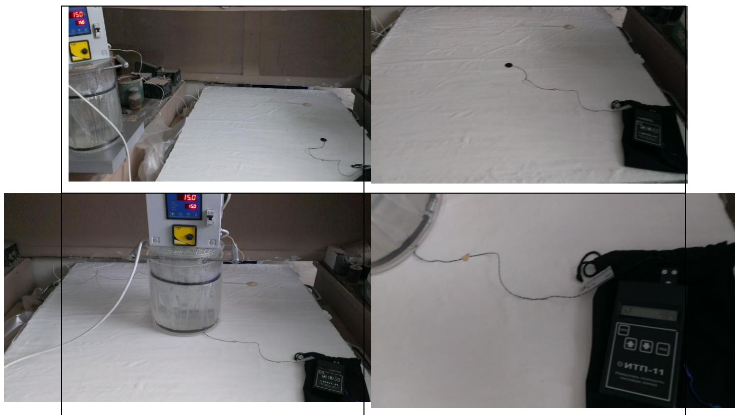
Рис. 14. Проведение испытаний образцов краски на основе микросфер.
