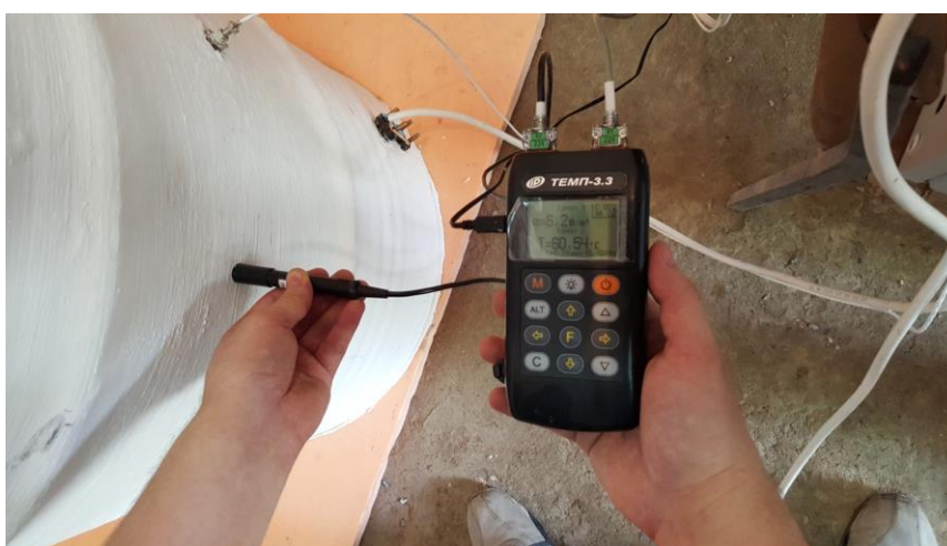
Рис.2. Измерение температуры поверхности окрашенной бочки.
