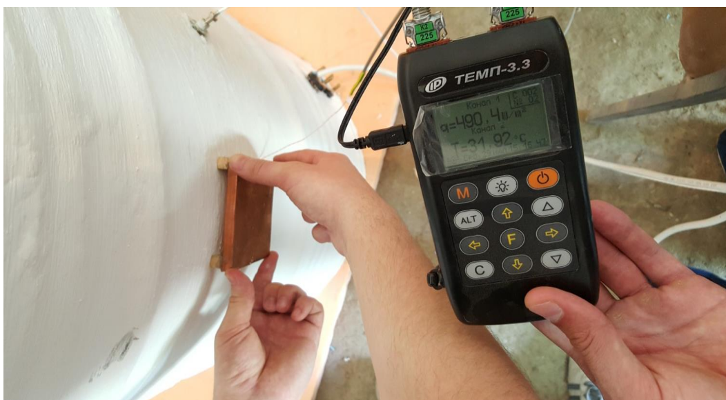
Рис.4. Измерение теплового потока окрашенной бочки.
